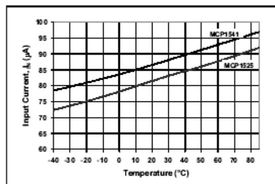
图 2-3 输入电流与温度关系
