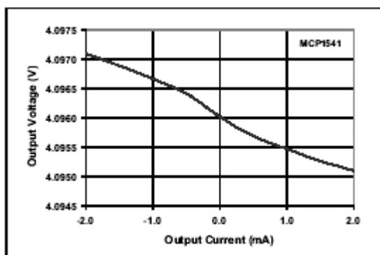
图 2-10 MCP1541 输出电压与输出电流关系
