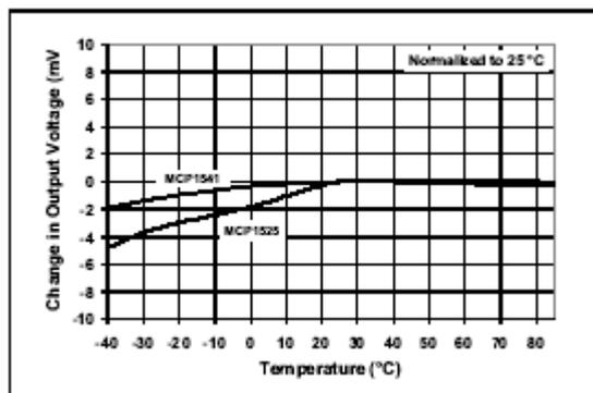
图 2-1 输出电压变化与温度对应关系
