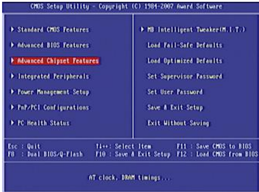
圖 / Award BIOS的開機順序設定在Advanced BIOS Features中
