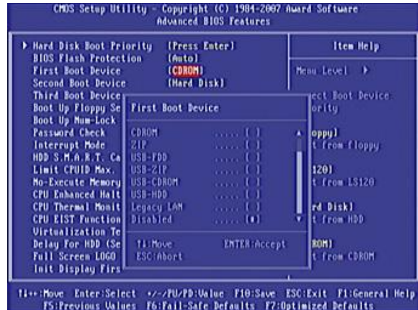
圖 / Award BIOS的開機順序設定在Advanced BIOS Features中
