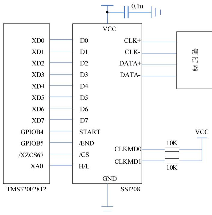
图 5 TMS320F2812 与 SSI208P 连接硬件设计原理图
