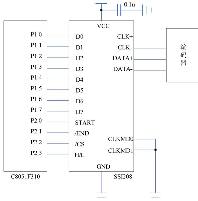
图 7 C8051F310 与 SSI208P 连接硬件设计原理图
