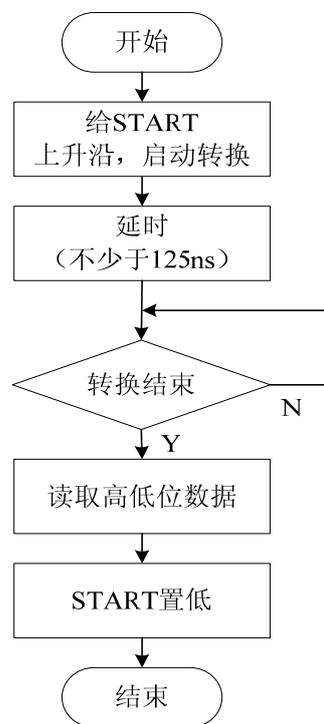
图6 SSI208P软件流程图
