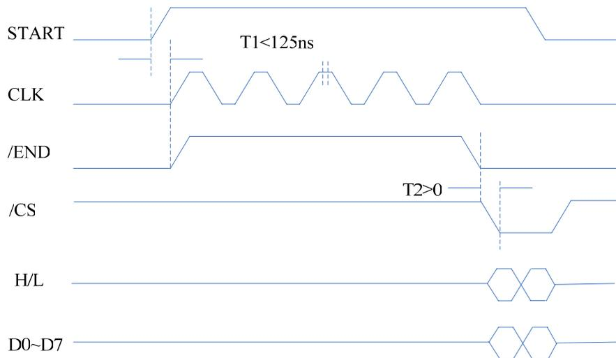
图 4 SSI208P 控制时序
