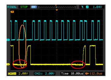
而LM75A则没有应答信号,也没有温度数据输出,波形跟没有焊LM75A时完全相同。LM75A没有正确的应答,后面也没有温度输出。于是初步认为LM75A为假或有质量问题。
