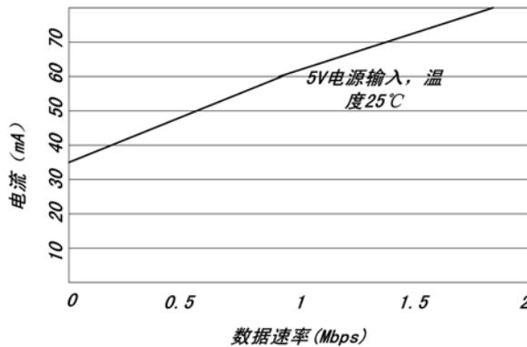
图 3.1 数据速率与电源输入电流对应关系
