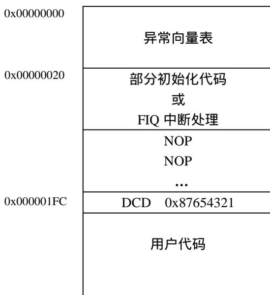
图 C.1 带有加密设置的程序结构图
