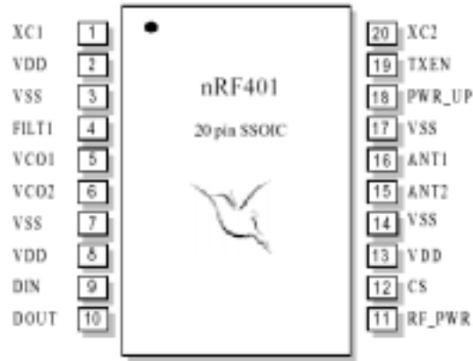
图 2 nRF401 管脚定义图
