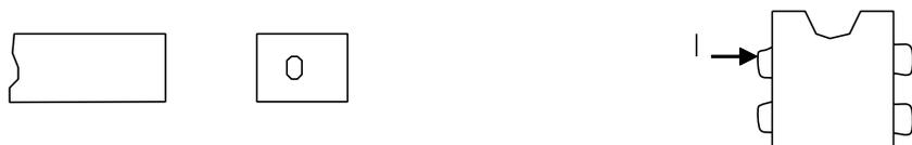
插第一号管脚的孔通常在电路板上用方盘或带尖角的焊盘标明。
