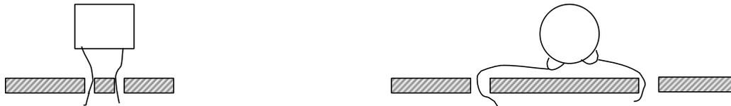
如果电路板上的孔不如元件体宽时，管脚应加套管。如果电路板上的两孔距离过宽时，也应加套管。大型的电容不是直接插的，它们是用带子象下图这样固定，然后用绝缘线连接两管脚，插入孔中。
