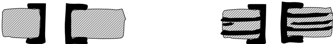
15. 连接孔——那些一般不用来插元件和布明线的金属化孔。
