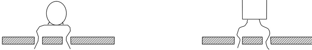
当电容管脚加上绝缘保护层时，绝缘保护层不可插入孔中。
