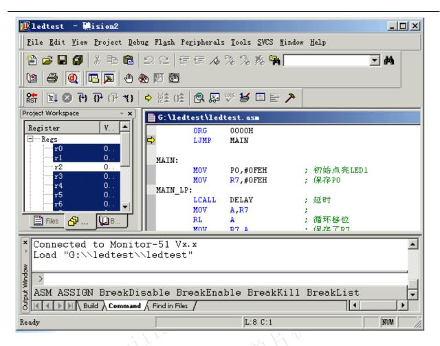
点击工具条上的 Run 按钮,程序开始全速运行,此时可以看到 8 个绿色的指示灯轮流被点亮。
