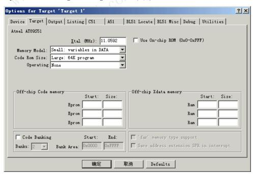
"Xtal": 定义 CPU 时钟, 我们的开发板上标配的晶振是 11.0592M 的, 在"Xtal"后边框中填入"11.0592"。下面依次是编译的存储模式,程序空间大小等设置,均使用默认值即可。
