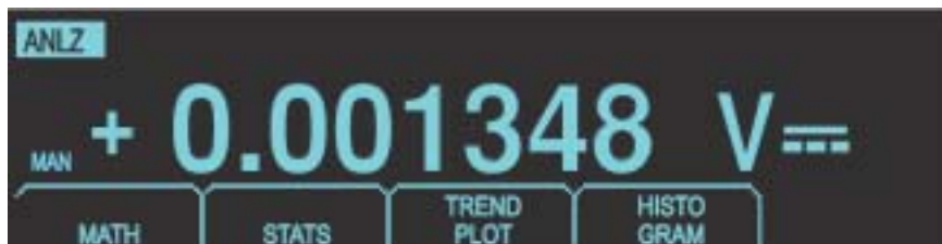
图 2. 884X 万用表的菜单可直接操作“STATS”（统计）和“HISTOGRAM”（分析）功能
