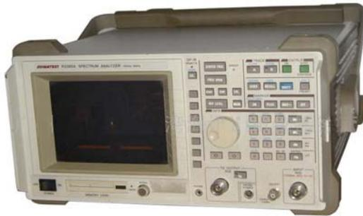
频谱仪主要应用在RF领域，进行高频信号的测量，但目前在EMC测量领域，也有大量的应用。频谱分析仪是电磁干扰（EMI）的测试、诊断和故障检修中用途最广的一种工具。
