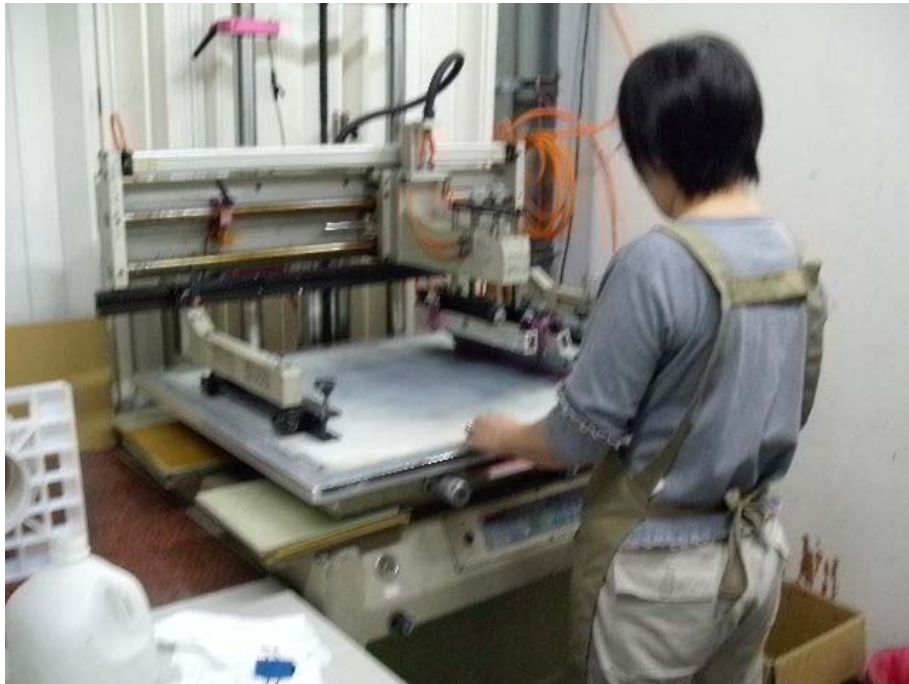
Photo 2. 以 120 mesh (48T) 丝网印刷
