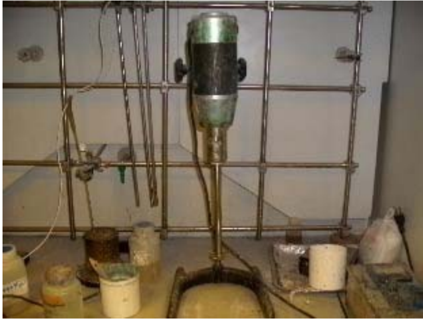
Photo 1. 主剂与硬化剂混合后，以小型均质分散机械搅拌均匀。
