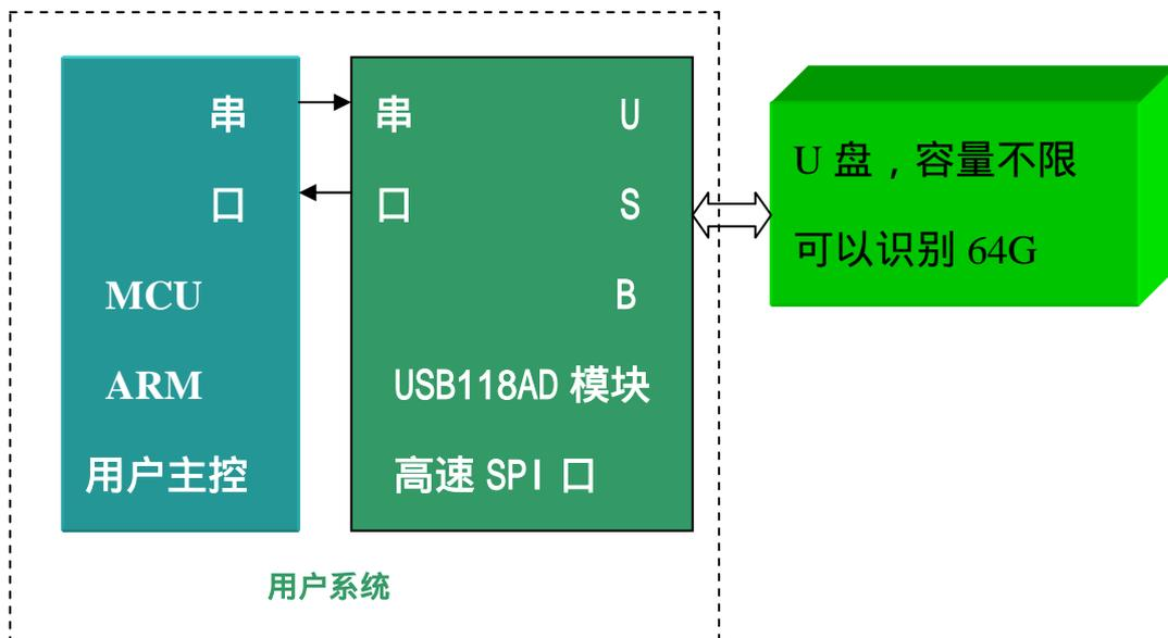
只要将 USB118AD 模块嵌入到用户系统中,用系统的主控单片机串口或者 SPI 口与 USB118AD 模块的通信接口连接,将外接 U 盘的 USB 插座引到设备壳体上,用户就可以非常方便的通过普通 U 盘实现仪器或设备数据的海量存储。
