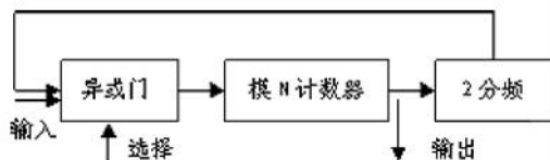
图2：通用分频器电路组成
