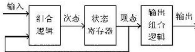
图1 输出由状态位经组合译码得到的有限状态机
