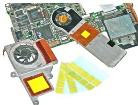
本材料是热量增强聚合物，设计用于满足高终端导热应用的导热、可靠性的需求。加之热阻小的通道使散热片的性能达到最佳，并且改善了微处理器，存储器模块 DC/DC 转换器和功率模块的可靠性。
