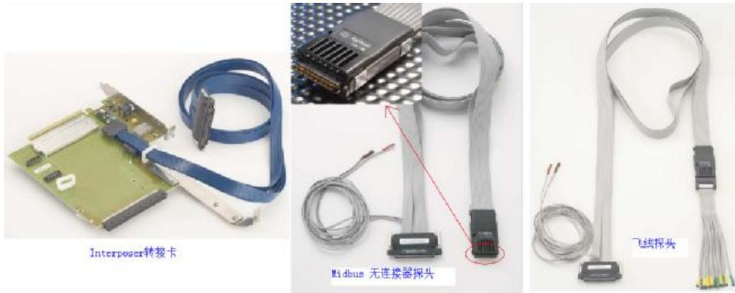
Interposer 转接卡适用于被测件上有标准 PCIE 接口的情况，它插在主板和插卡的标准的 PCIE 插槽间，可以把中间的数据流捕获下来，这是最方便的一种连接方式。Mi dbus 是一种无连接器的探头，适合于嵌入式系统的应用，用户可以在布 PCB 板时事先把被测信号连接到按一定规则排列的裸焊盘上，Mi dbus 探头的前端是 2 排有弹性的测试针，可以可靠地刺在焊盘上完成测试。如果用户前两种方法都不能采用，则可以考虑第 3 种飞线探头的探测方式，通过把飞线探头的前端焊接在被测信号上完成测试，这是最灵活的一种探测方式。Agilent 是唯一能够同时提供这 3 种 PCIE 探测方式的公司。
