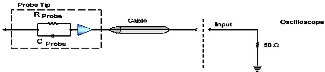
有源探头的前端有一个高带宽的放大器，放大器是需要供电的，这也是有源探头名称的由来。我们知道放大器的输入阻抗都是比较高的，所以有源探头可以提供比较高的输入阻抗；同时放大器的输出驱动能力又很强，所以可以直接驱动后面 50 欧姆的负载和传输线。由于 50 欧姆的传输线可以提供很高的传输带宽，再加上放大器本身带宽较高，所以整个探头系统相比无源探头就可以提供更高带宽。
