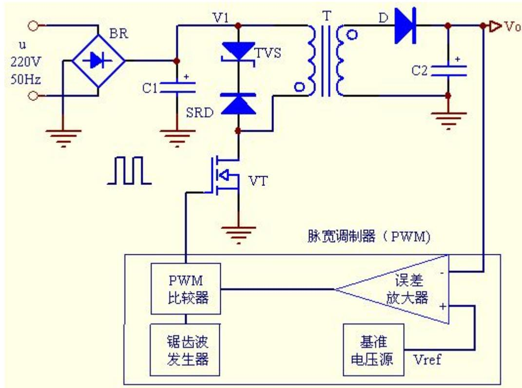
交流 220V 电压经过整流滤波后变成直流电压  $V_1$ ，再由功率开关管（双极型或 MOSFET）斩波、高频变压器  $T$  降压，得到高频矩形波电压，最后通过整流滤波器  $D$ 、 $C_2$ ，获得所需要的直流输出电压  $V_o$ 。脉宽调制控制器是其核心，它能产生频率固定而脉冲宽度可调的驱动信号，控制功率开关管的通断状态，来调节输出电压的高低，达到稳压目的；锯齿波发生器提供时钟信号；利用误差放大器和比较器构成闭环调节系统。
