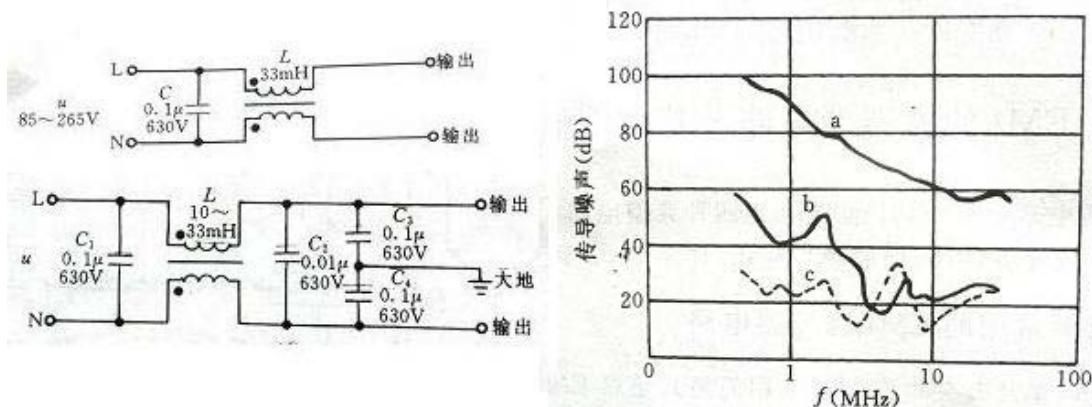
a 为无滤波器的传导噪声特性曲线，b 为加简单滤波器后的曲线，衰减 40dBuV，c 为加完整滤波器的曲线，衰减 50~70dBuV。而滤波器中关键器件是共模扼流圈，主要用于抑制传导干扰，频谱主要在 10kHz~30MHz，最高到 150MHz：
