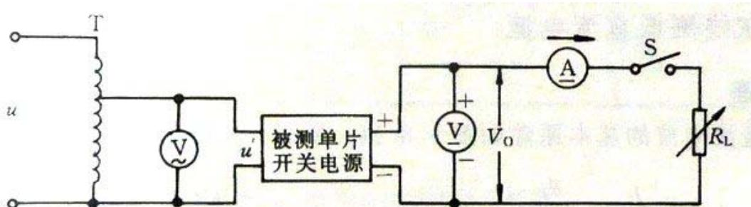
1. 输出电压的准确度：开关电源加上标称输入电压和额定负载，用实测输出电压并与标称电压比较
