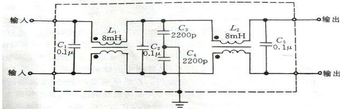
对于小功率开关电源可采用简易式 EMI 滤波器：用两个分立的铁氧体磁环线圈或螺线管线圈所构成，用于 5W 以下，电感 1mH
