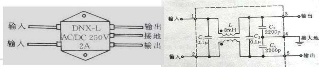
其中：C1、C2 采用薄膜电容，容量 0.01~0.47uF，主要用来滤除串模干扰。耐压 630Vdc 或 250Vac。
