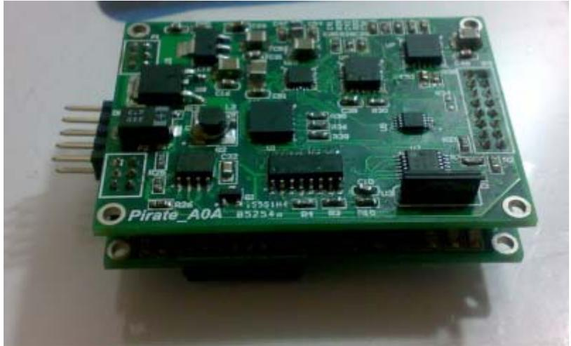
kalman滤波，输出实时的姿态数据，由于采用三轴加速度计和三轴电子罗盘辅助三轴陀螺以及温度补偿的算法技术，使得该产品能实现实时的全姿态，姿态永久不会漂移发散的效果，在一些低成本的应用场合值得推崇。该产品不仅能输出姿态数据，通过修改系统参数，也能输出传感器原始数据，物理量，四元数等；同时还能修改系统运行周期，方便各种借口，采用片上flash IAP（in application program）技术，可根据用户的需求，保持用户的参数，断电后仍然能记忆，有利于用户的二次开发
