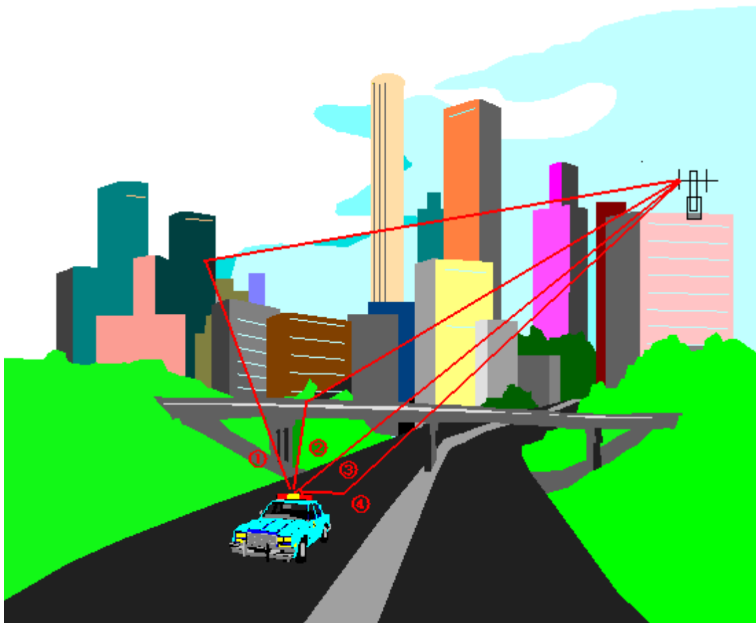
① 建筑物反射波 ② 绕射波 ③ 直达波 ④ 地面反射波
