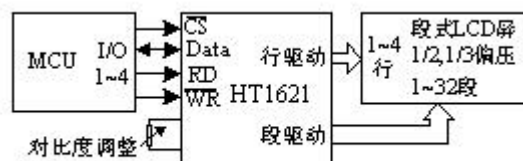
图1 段式LCD的控制驱动与接口
