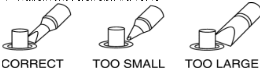
图 3-8 TIP 头的大小与元件直径的关系示意图
