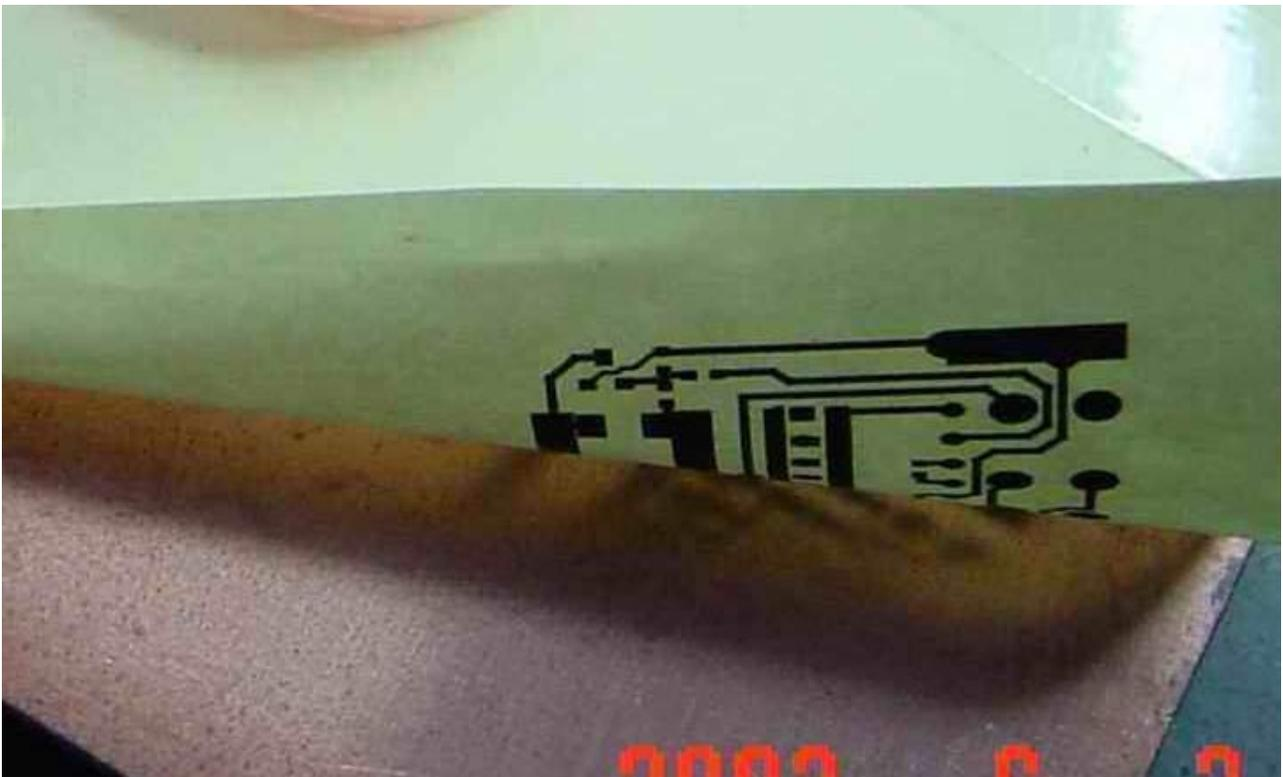
第 4 步：用电熨斗加温（要很热）将转印纸上黑色塑料粉压在覆铜板上形成高精度的抗腐层
