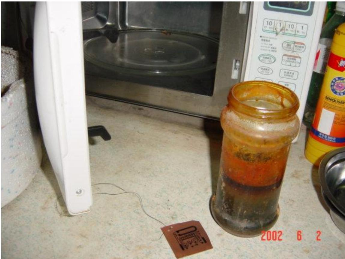
第7步：效果还不错吧！注意不要腐蚀过度，腐蚀结束，准备焊接。
