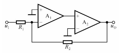
首先判断是电压还是电流反馈:将输出短路,显然在输入端将不会形成反馈信号,所一是电压反馈。此时若不判断是并联还是串联反馈将极有可能得出反馈回路的放大倍数为:
