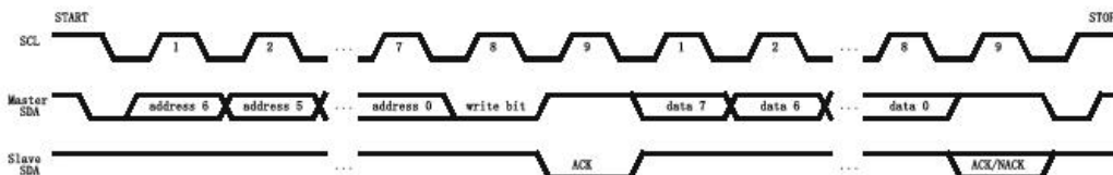
图 10 主机向从机发送 1 字节数据的时序图
