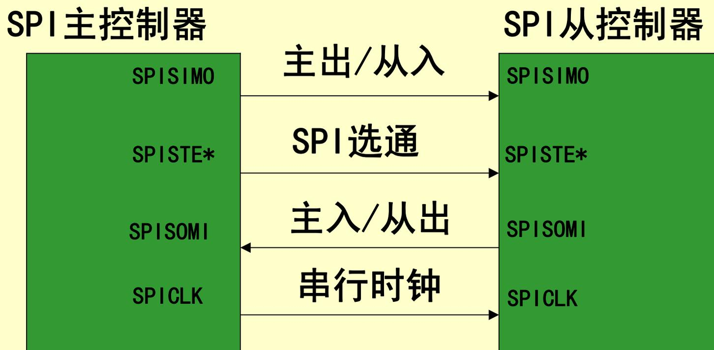
图9-2 SPI主/从控制器连接
