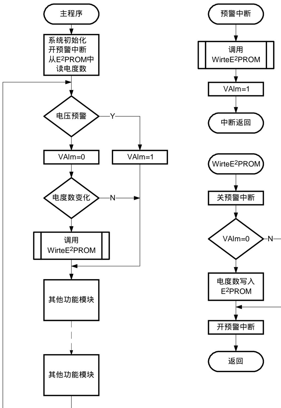
图 10. 电表应用中 E<sup>2</sup>PROM 数据保护程序流程图
