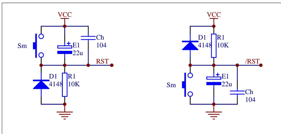
图2 增加放电回路的RC复位电路
