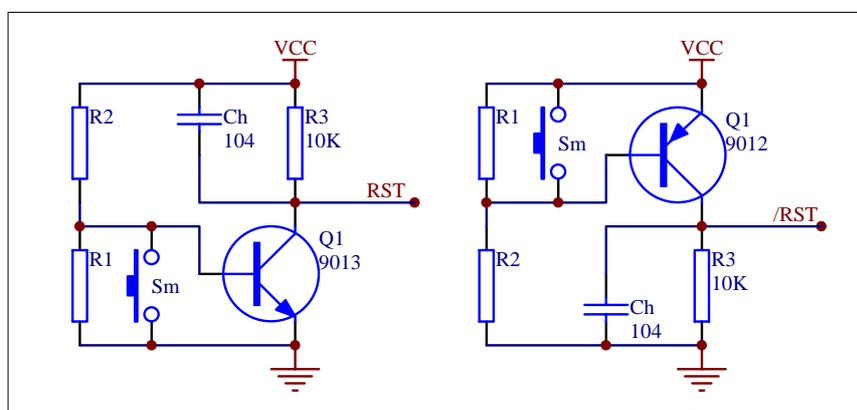
图4 带电压监控功能的复位电路
