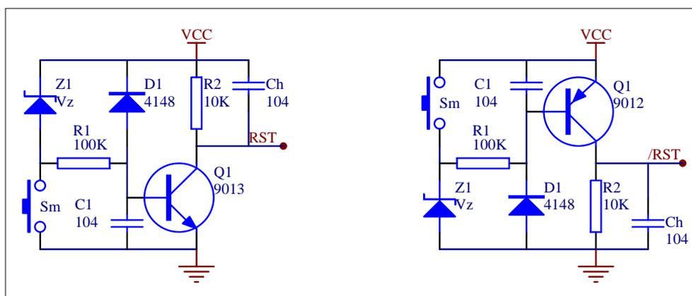
图 6 实用的复位监控电路
