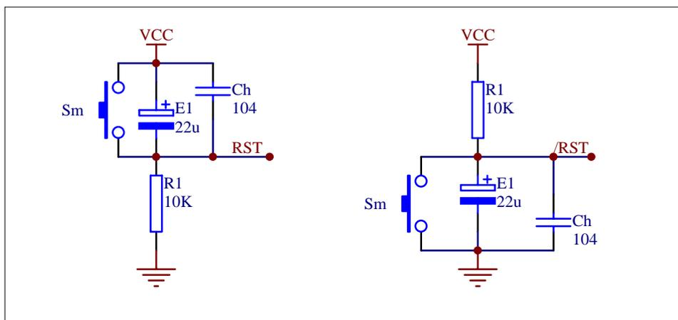
图 1 RC 复位电路
