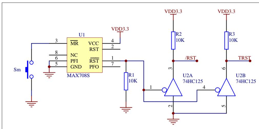
图 13. 用 PHILIPS MAX708 实现的 ARM 复位电路
