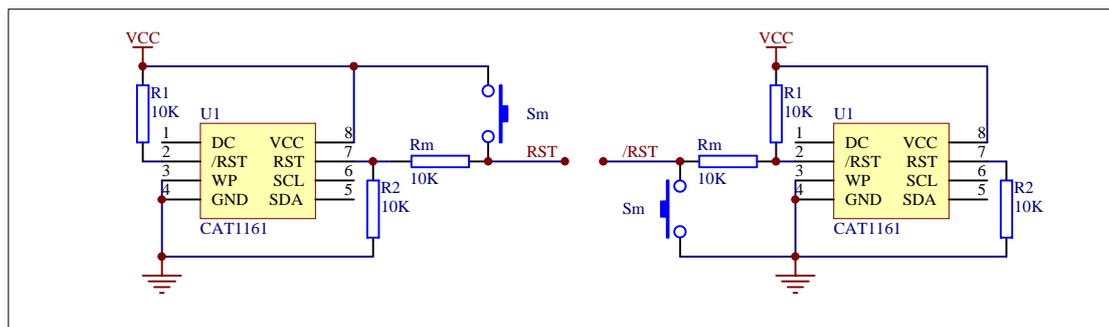
图 11. 内置 WDT+RESET+RESET+E<sup>2</sup>PROM 监控器件接口电路
