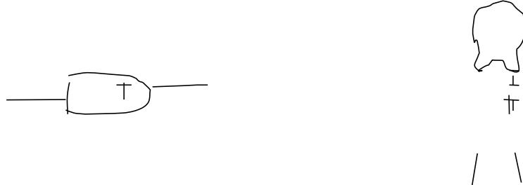
另一些暖和圆点、细的一端、有缺口的一端、长的管脚的一端表示正方向。
