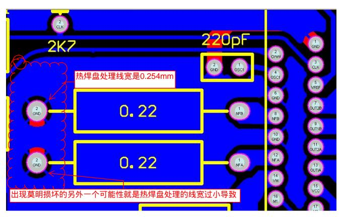
注意敷铜后接地引脚连线线宽的变化。因为热焊盘的处理,虽然方便于焊接,但如果连接的线宽偏小,极可能会导致芯片过流损坏。图中热焊盘处理用的是 0.254mm 的线宽
