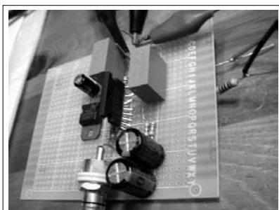
图3 用于测试负载特性的实验电路板
