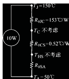
图 A-8 A.6.1 设计举例中的热模型
