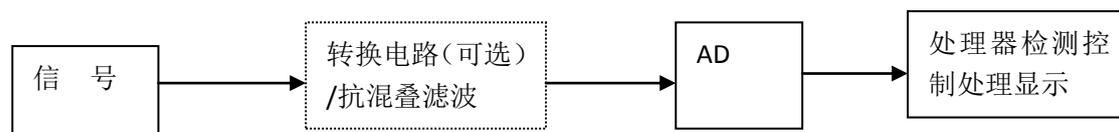
转换电路的功能就是将微弱信号转为可测信号，某些条件下信号可能非常微弱，同时需要测量的量跟幅度也没关系，那可能就需要转换电路。
