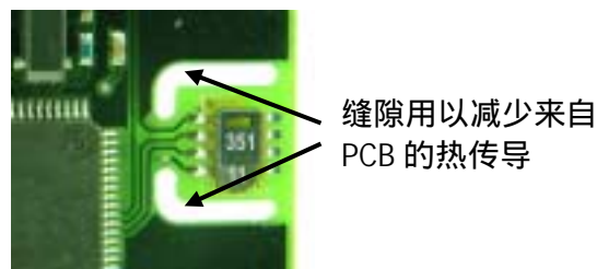
图 13 SHT1x PCB 安装举例
