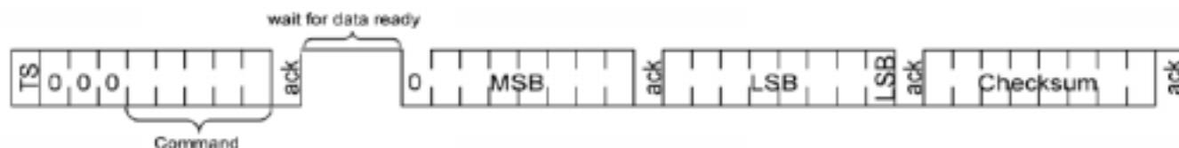
图 6 测量时序概览 (TS = 启动传输)
