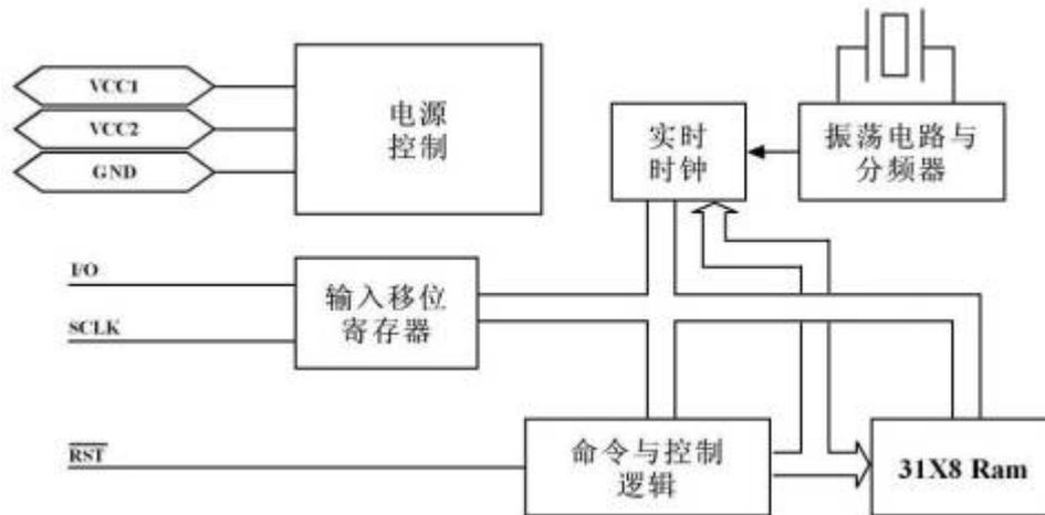
图4 DS1302的内部结构图
