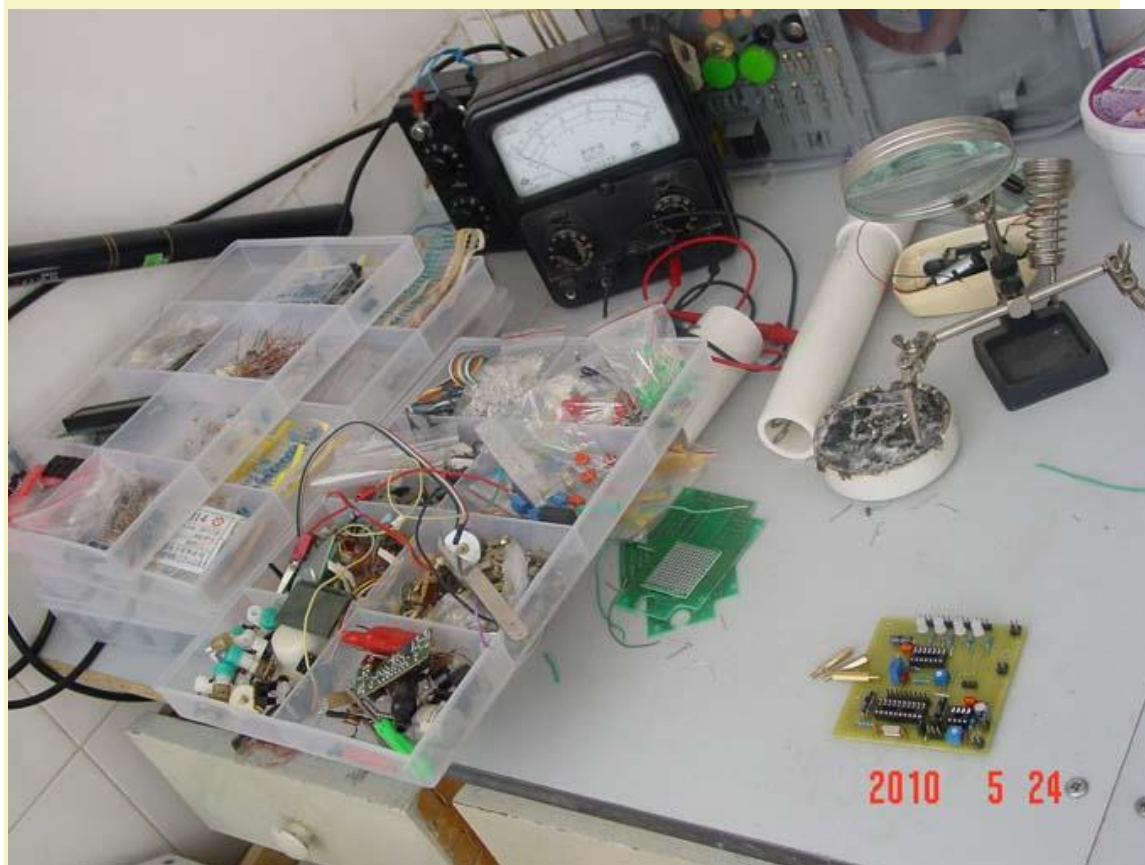
刚焊接完成的红外线传感器、音频放大板。
