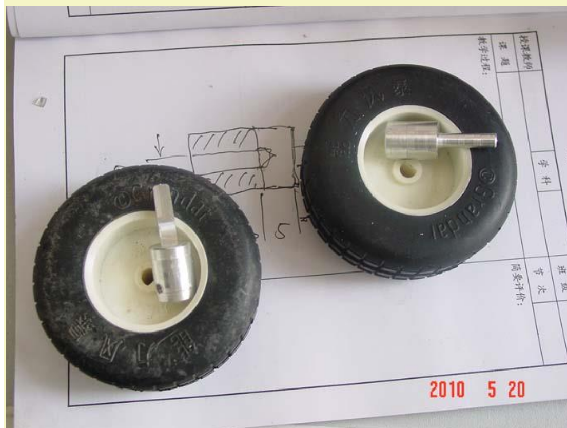
加工好的电机连接轴和待用的小车轮。
