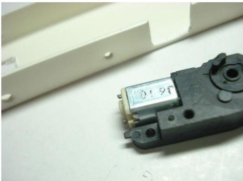
用 M2\*10 的螺丝螺母把减速电机固定到躯干侧边上。
