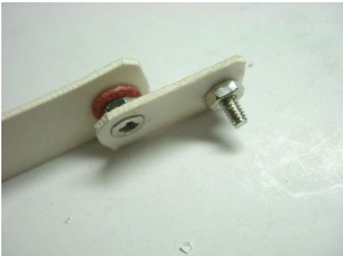
把作为短轴用螺丝刀拧入减速电机转盘上的轴孔。注意，可能稍微有点紧，要用一点力才能拧入。
