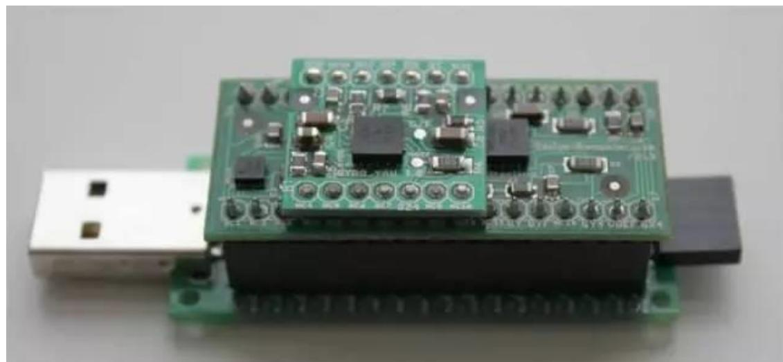
IMU 单元例子：上图中 MCU 顶端的 ACC Gyro 6DOF，名为 USBThumb，支持 USB/串口通信
