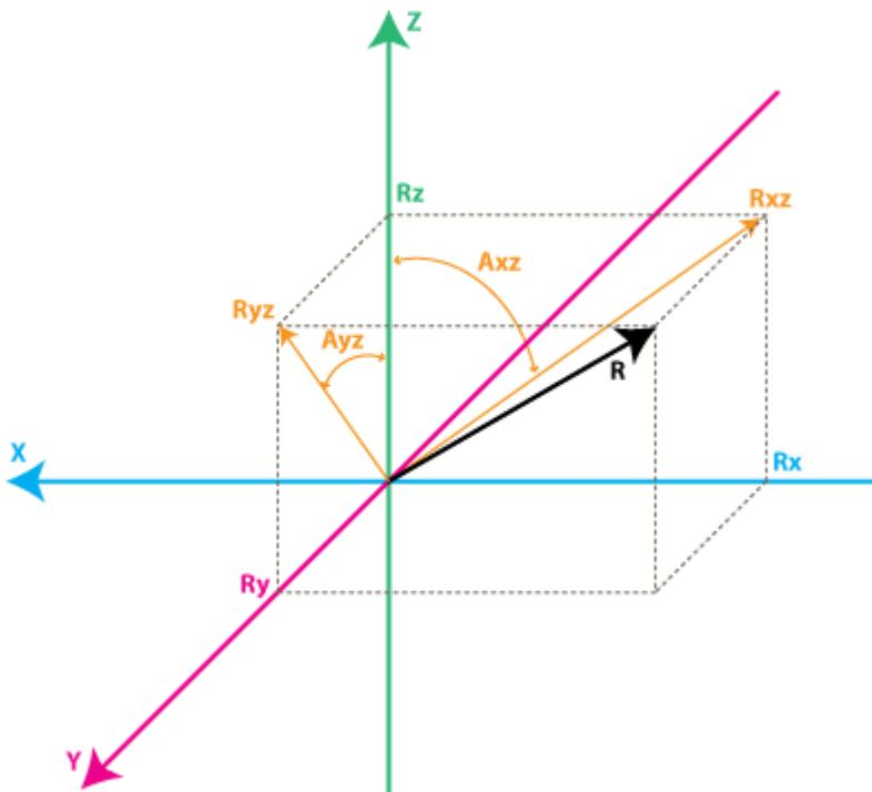
陀螺仪的每个通道检测一个轴的旋转。例如，一个 2 轴陀螺仪检测绕 X 和 Y 轴的旋转。为了用数字来表达这些旋转，我们先引进一些符号。首先我们定义：
