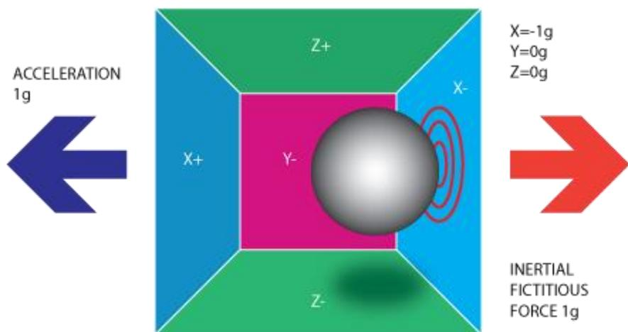
请注意加速度计检测到得力的方向与它本身加速度的方向是相反的。这种力量通常被称为惯性力或假想力。在这个模型中你你应该学到加速度计是通过间接测量力对一个墙面的作用来测量加速度的，在实际应用中，可能通过弹簧等装置来
