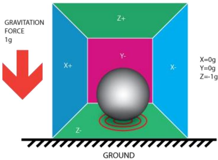
在这种情况下盒子没有移动但我们任然读取到 Z 轴有  $-1g$  的值。球在墙壁上施加的压力是由引力造成的。在理论上，它可以是不同类型的力量 - 例如，你可以想象我们的球是铁质的，将一个磁铁放在盒子旁边那球就会撞上另一面墙。引用这个例子只是为了说明加速度计的本质是检测力而非加速度。只是加速度所引起的惯性力正好能被加速度计的检测装置所捕获。
