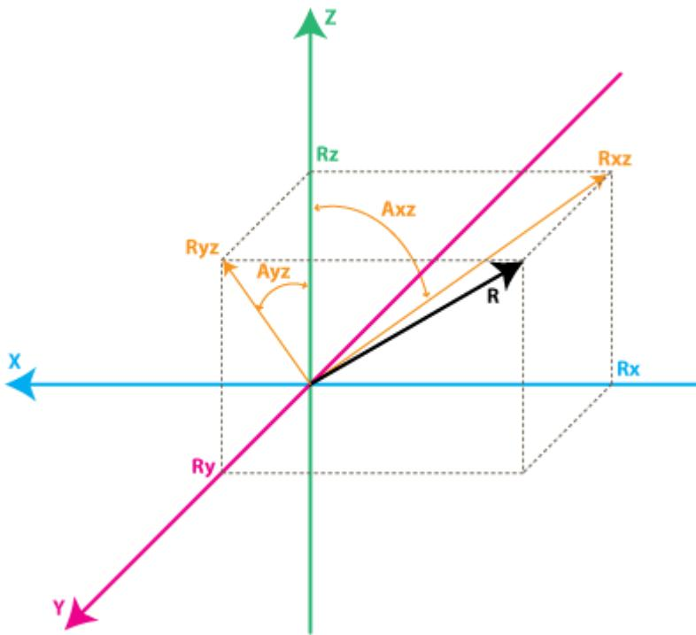
首先观察陀螺仪模型中下面的关系，根据由  $R_z$  和  $R_{xz}$  组成的直角三角形我们能推出：
