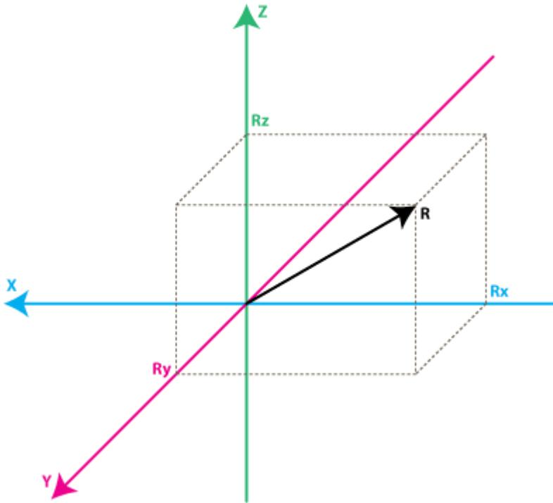
请看看在上面的模型，我保留了轴的颜色，以便你的思维能更好的从上一个模型转到新的模型中。想象新模型中每个轴都分别垂直于原模型中各自的墙面。矢量 R 是加速度计所检测的矢量（它可能是重力或上面例子中惯性力的合成）。RX, RY, RZ 是矢量 R 在 X, Y, Z 上的投影。请注意下列关系：
