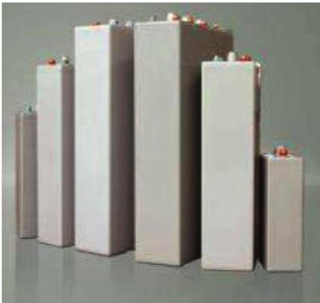
蓄電池採用凝膠狀的膠體電解液，正常使用时保持氣密和液密狀態，當內部氣壓超過預設值時，安全閥自動開啟，釋放氣體，當內部氣壓降低後，安全閥自動閉合使其密封，防止外部空氣進入電池內部。電池在使用壽命期間，正常使用情況下無需補加電解質。
