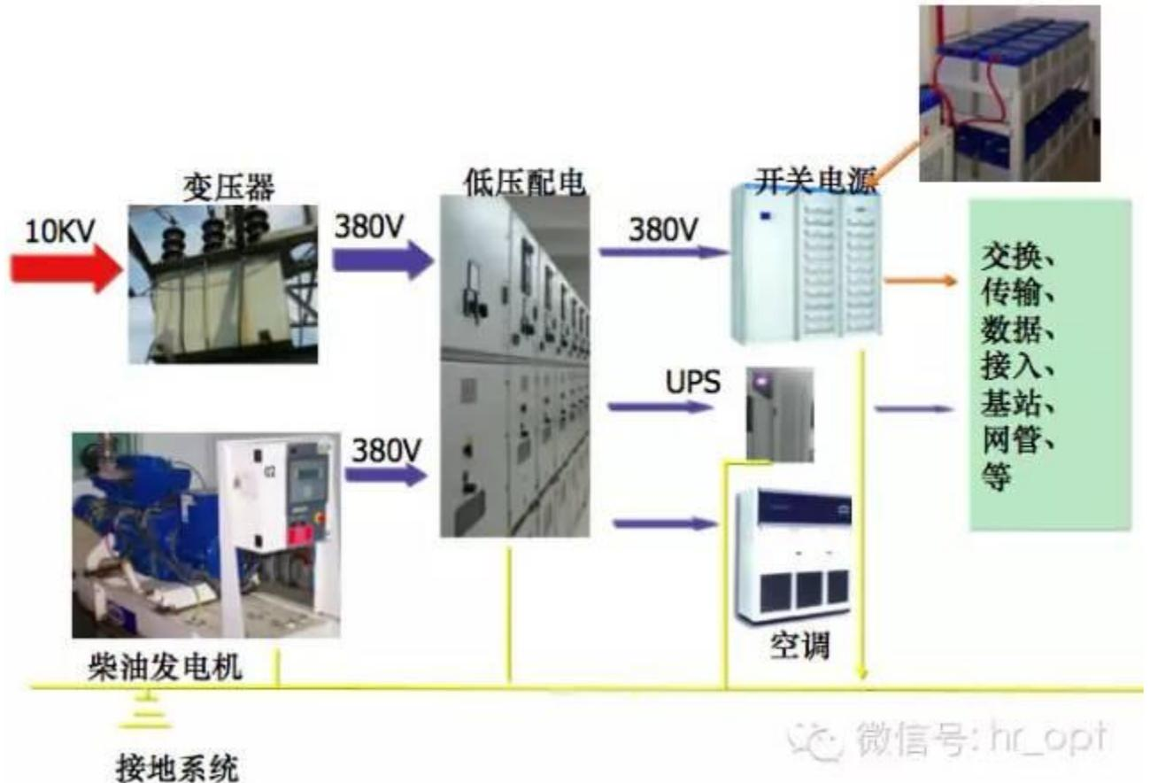
通信电源设备和设施主要包括：交流市电引入线路、高低压局内供配电设备、油机发电机组、整流器、蓄电池组、直流变换器、UPS、以及各种交直流配电屏等，组成一个完整供电系统，合理的进行控制、分配、输送，满足通信设备的要求。
