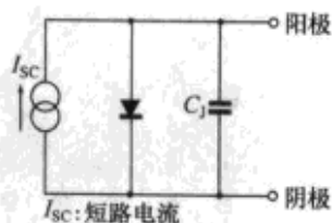
图1.2 光敏二极管的等效电路
