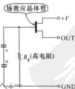
图 2.2 热释电型红外传感器的内部电路
