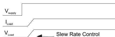
图 7. 使用负载开关的转换率控制
