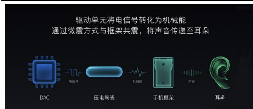
图 22: 小米 MIX 使用的是压电陶瓷方案
