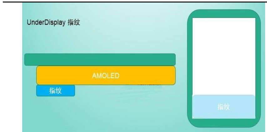
图 21: Under Display 指纹识别是最合适全面屏的
