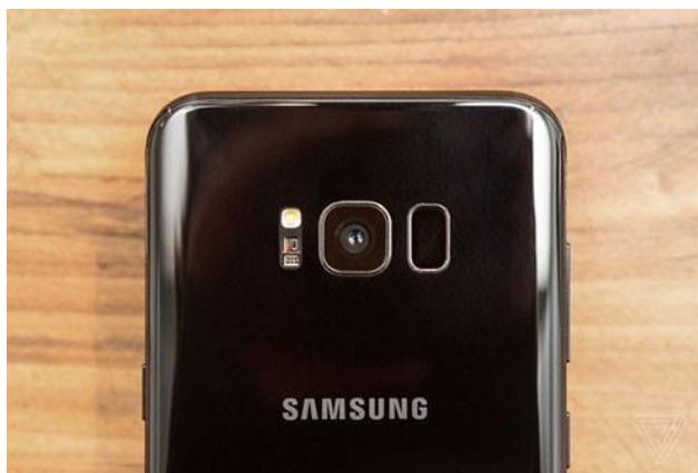
图表 20: 三星 S8 采用的后置指纹识别方案
