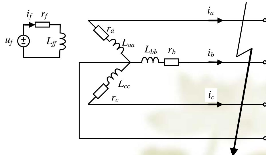
短路发生的瞬间，定转子各相绕组磁链维持为短路前初值不变
