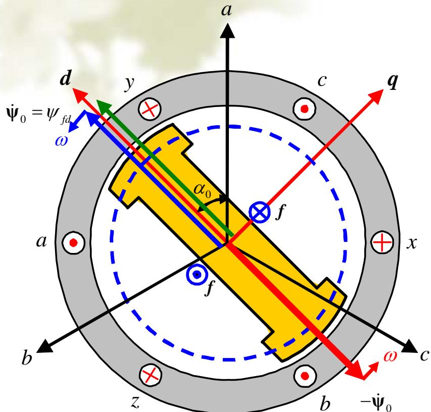
短路发生的瞬间，定子各相绕组磁链维持为短路前瞬间初值不变
