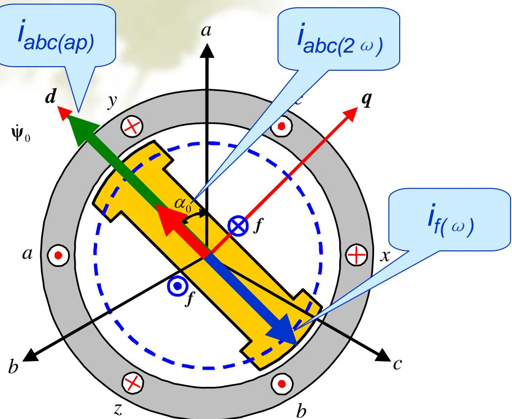
定子非周期电流产生空间静止磁势，会在转子绕组中感生基频电流
