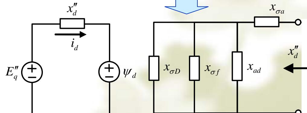
纵轴次暂态电抗  $x''_d = x_{\sigma a} + x_{ad} // x_{\sigma f} // x_{\sigma D}$
