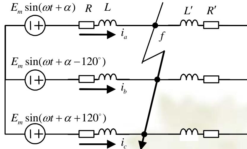
$$i = i_p + i_{ap} = I_{pm} \sin(\omega t + \alpha - \varphi) + C \exp(-t/T_a)$$
