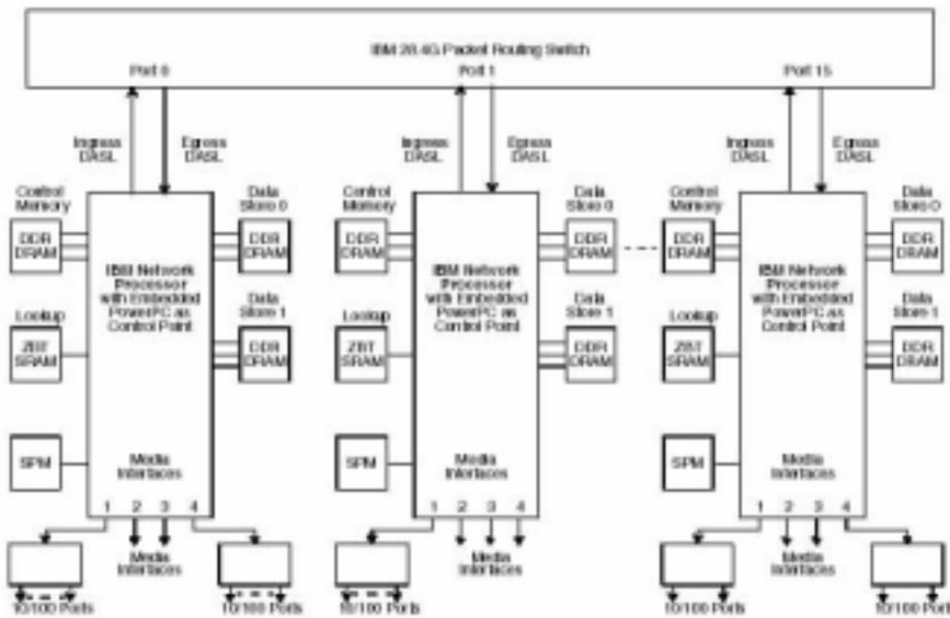
硬件转发分布式路由器是使用中心交换方式提高系统容量的另一种办法。这种系统的特征是，核心为大容量交换网络，交换网络外挂网络处理器，网络处理器上挂线路接口。整个转发系统是星形结构，中心是交换网络。交换网络使用信元
