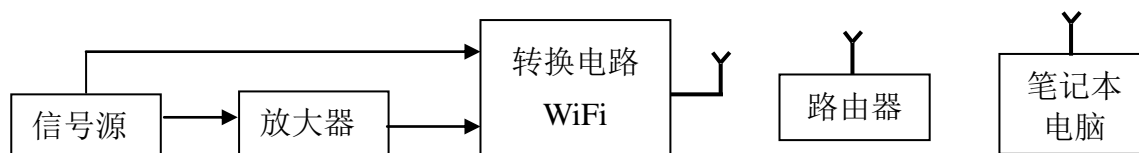
图 3 WiFi 信道幅频特性测试装置框图（发挥部分（3））
