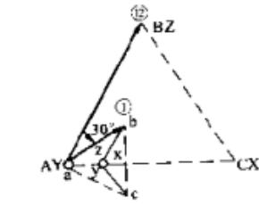
图 3-15 三相变压器内部接线不变，高低压侧线端同时改变时，组别的变化（五）
