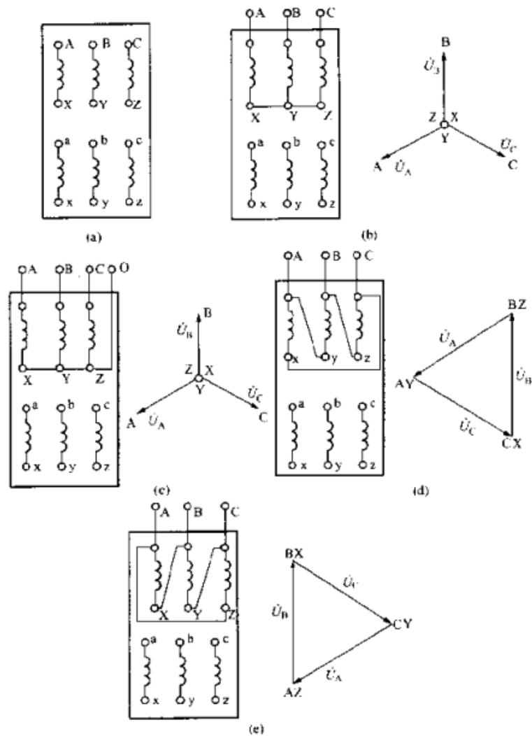
图 2-3 三相变压器绕组基本接法
