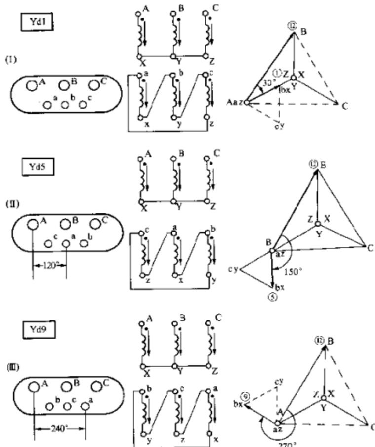
图 3-6 内部接线相同的 1-5-9 组变压器
