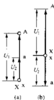
图 1-5 一次侧、二次侧电压相量图
