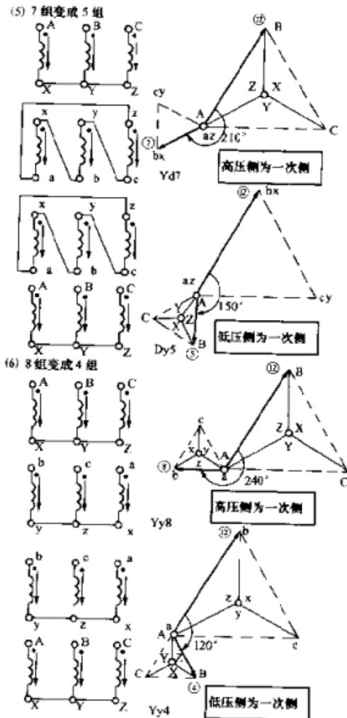
图 3-19 三相变压器内部接线不变，高低压侧互为一次侧时，接线组别的变化（三）
