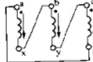
图 3-5 三相变压器基本接线方法的接线组别判断（四）
