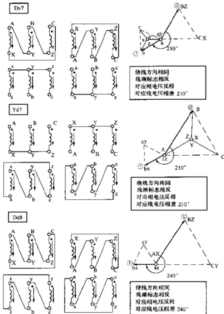
图 3-5 三相变压器基本接线方法的接线组别判断（五）
