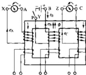
图 2-8 用直流法测定三相变压器三相间极性（反摆）
