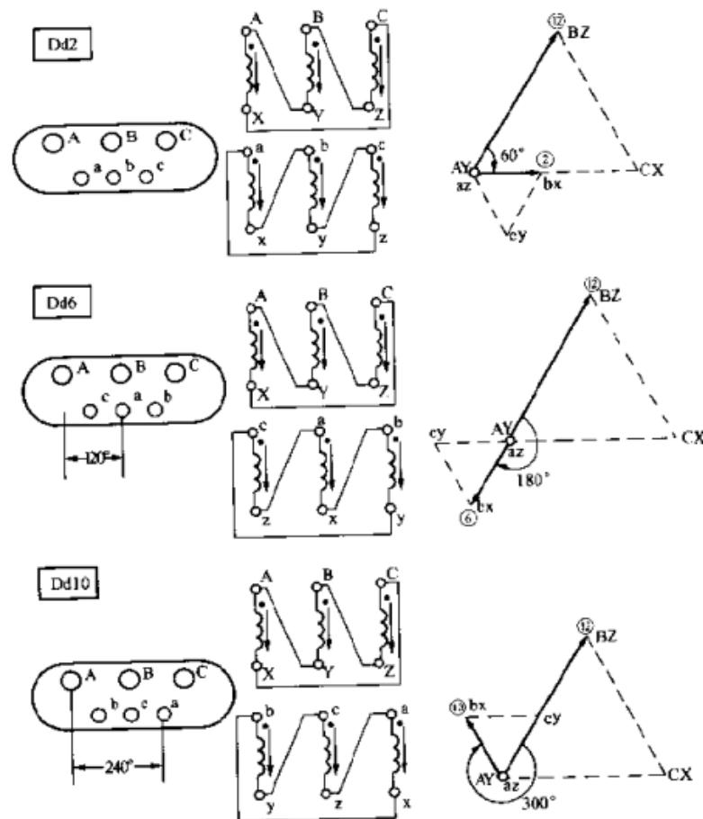
图 3-8 内部接线相同，一次侧线端标志相同的 2-6-10 组
