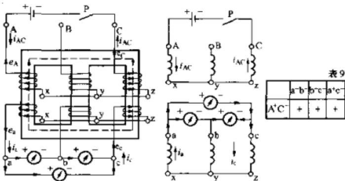
图 5-12 直流法测 Yy12 组别 (AC 相通电)
