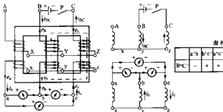
图 5-11 直流法测 Yy12 组别 (BC 相通电)
