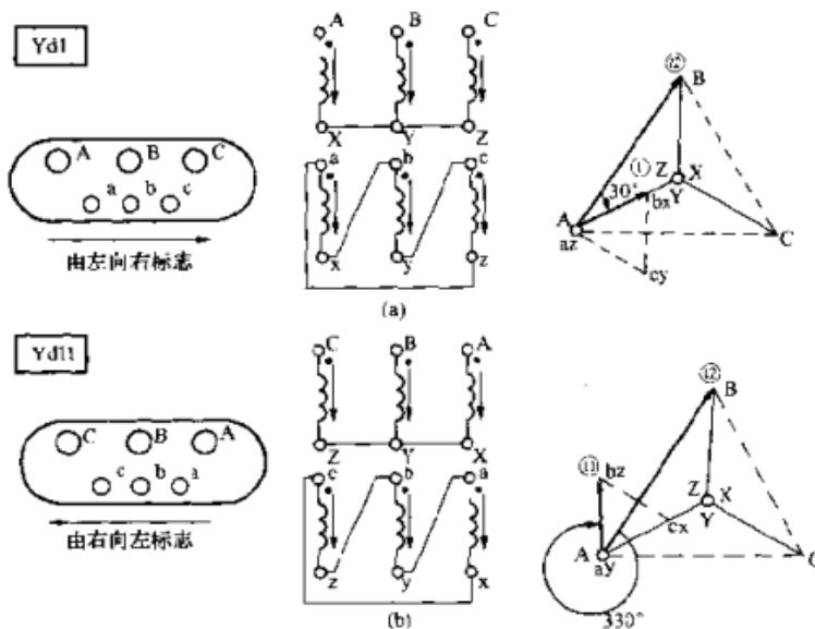
图 3-10 内部接线相同，一、二次侧标志顺序相反的 1~11 组
