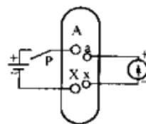
图 1-14 用直流毫伏表法测定单相变压器的极性
