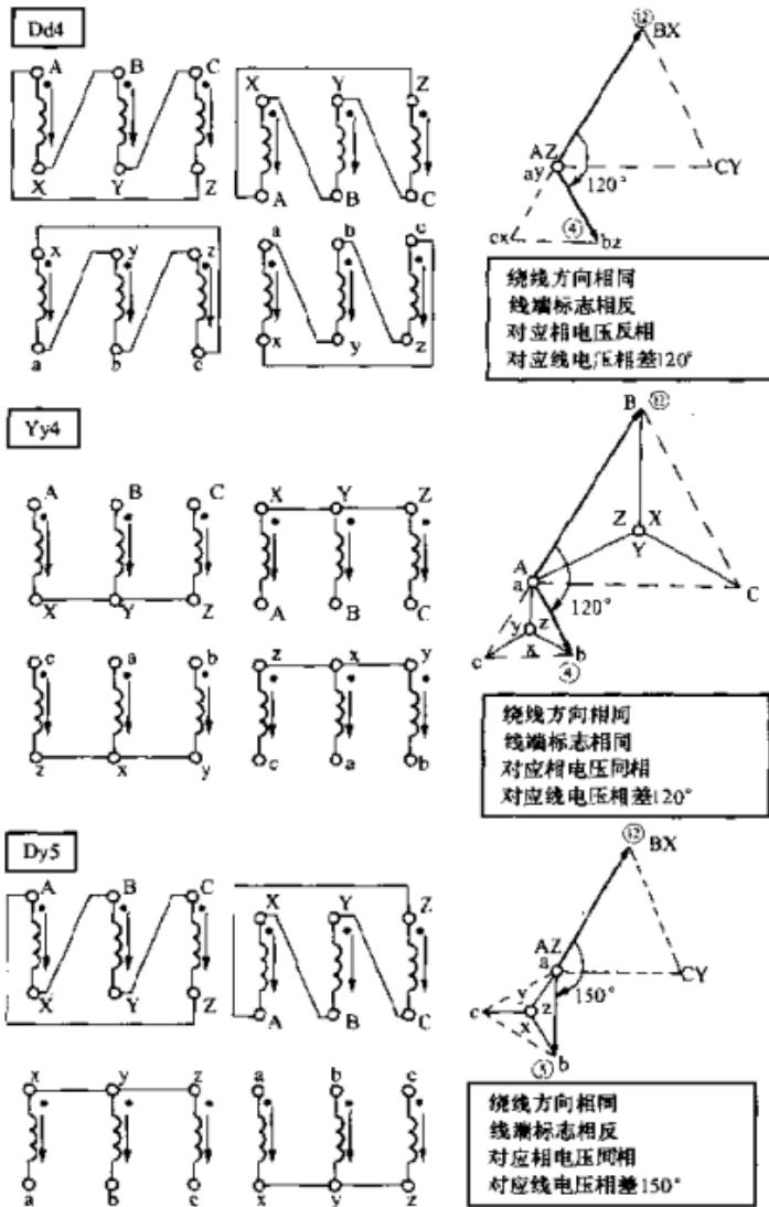
图 3-5 三相变压器基本接线方法的接线组别判断（三）
