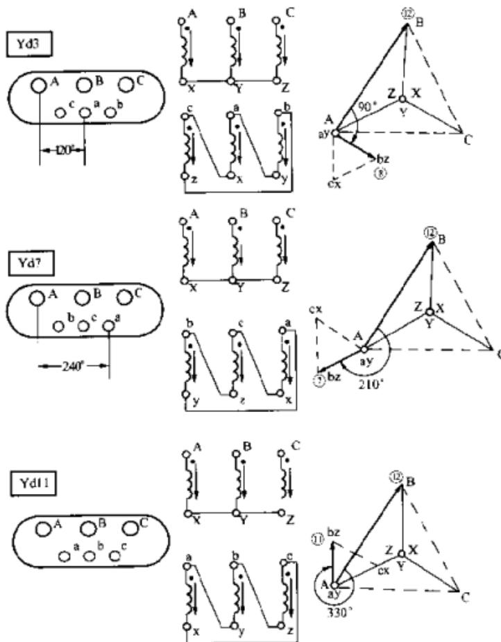
图 3-7 内部接线相同，一次侧线端标志相同的
