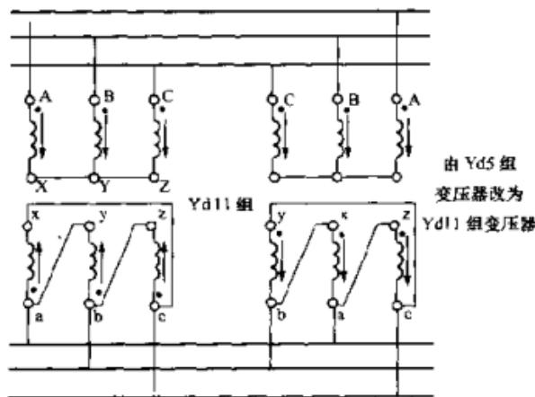
图 4-3 Yd11 组变压器并联运行由 Yd5 组变压器
