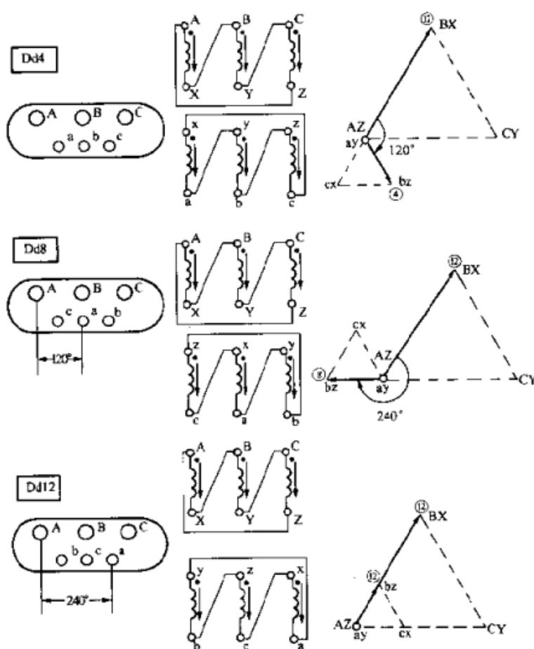
图 3-9 内部接线相同，一次侧线端标志相同的 4-8-12 组
