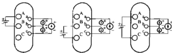
图5-9 直流法测三相变压器组别
