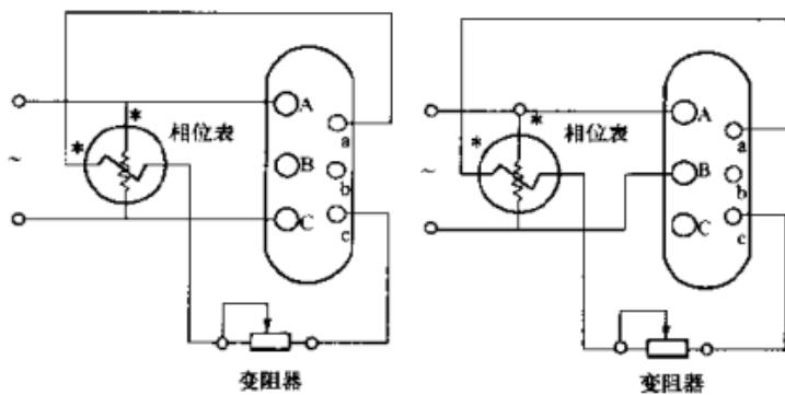
图 5-8 相位表法测定三相变压器组别
