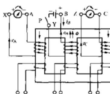
图 2-7 用直流法测定三相变压 P 的瞬间，两表同时向正方
