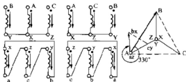
图 4-4 内部接线不变，改变外部线端标志的 Yd11 组
