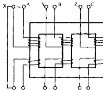
图 2-6 用交流法测定每相高低压绕组极性
