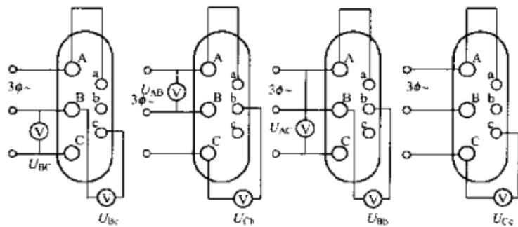
图 5-1 交流法测定三相变压器接线组别
