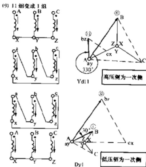
图 3-21 三相变压器内部接线不变，高低压侧互为一次侧时，接线组别的变化（五）
