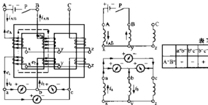
图 5-10 直流法测 Yy12 组别 (AB 相通电)
