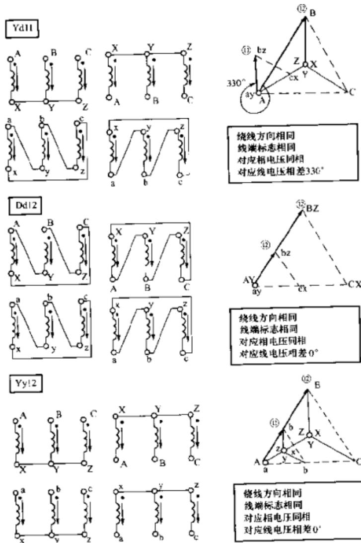
图 3-5 三相变压器基本接线方法的接线组别判断 (八)
