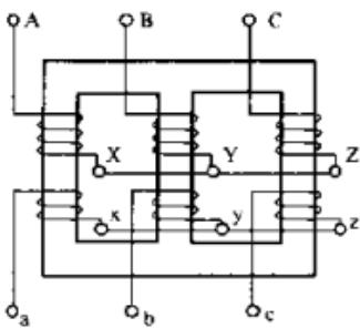
图 2-2 芯式三相变压器
