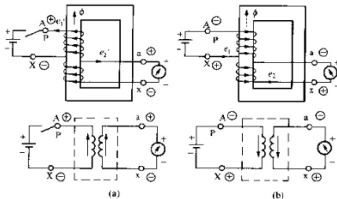
图 1-15 合闸时正摆、拉闸时反摆为减极性变压器
