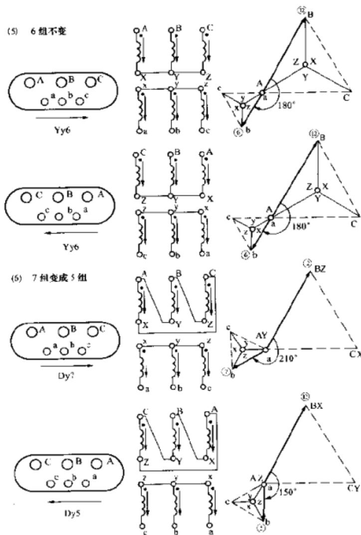
图 3-13 三相变压器内部接线不变，高低压侧线端同时改变时，组别的变化（三）
