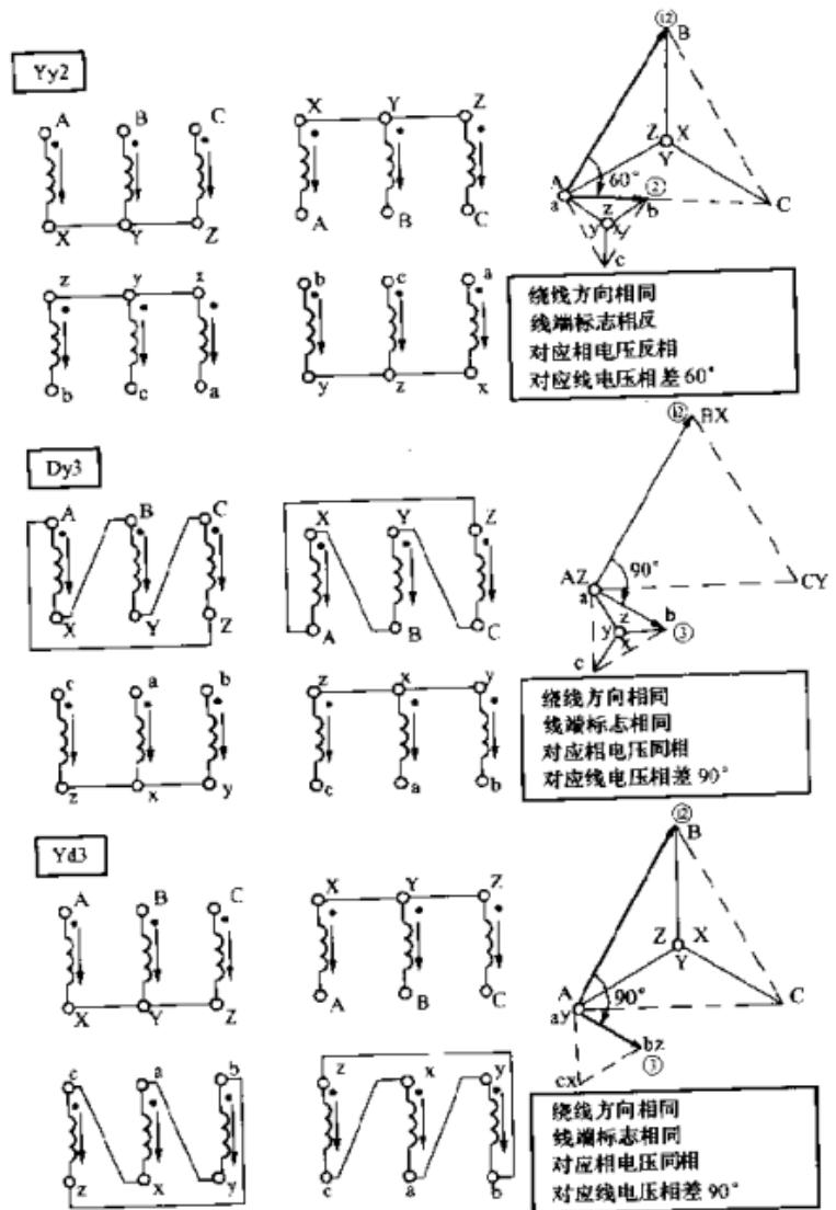
图 3-5 三相变压器基本接线方法的接线组别判断（二）
