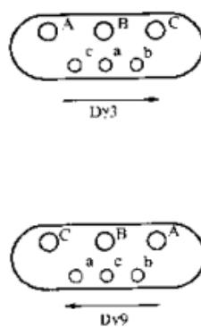
图 3-11 三相变压器内部接线不变，高低压侧线端同时改变时，组别的变化（一）
