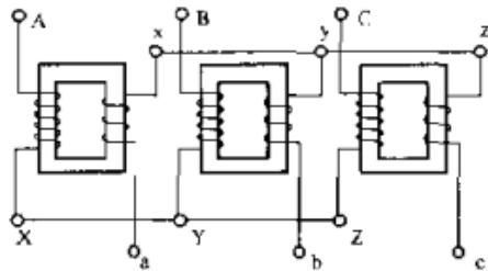
图 2-1 组式三相变压器
