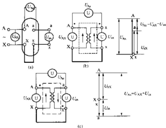
图 1-12 用交流法测定单相变变压器的极性
