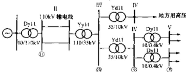
图 4-5 输电系统中 Yd11 组变压器变压后
