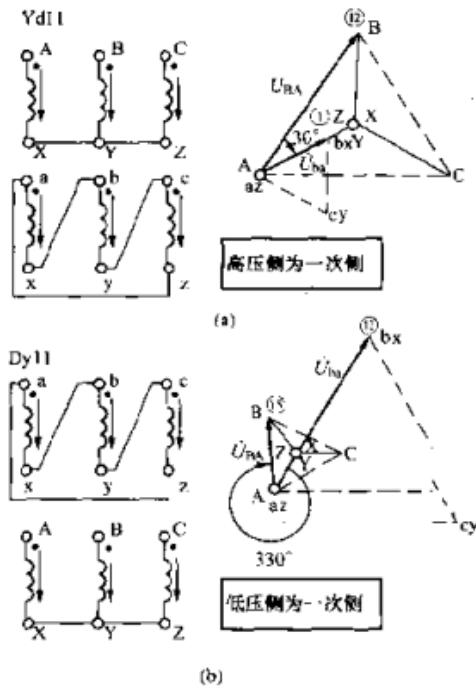
图 3-16 内部接线不变, 高低压侧互为
