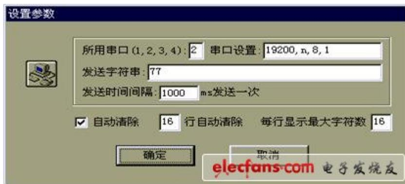
设置完后，按确定返回主界面，注意右边有一个下拉列表，应当选中“按 16 进制”。然后按“开始发送”、“开始接收”就能了。按此设置，实验板上应当有两只灯亮，6 只灯灭。大家能自行更改设置参数中的发送字符如 55, 00, FF 等等，观察灯的亮灭，并分析原因，也能在主界面上更改下拉列表中的“按 16 进制”为“按 10 进制”或“按 ASCII 字符”来观察现象，并仔细分析。这对于大家理解 16 进制、10 进制、ASCII 字符也是很有好处的。程序本身很简单，又有注释，这里就不详加说明了。
