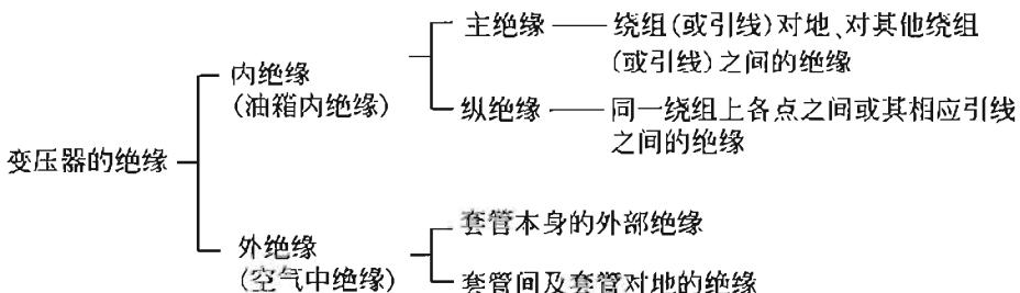
变压器的引线是指各线圈之间、线圈与出线套管之间、线圈与分接开关之间的连接导线。变压器的引线绝缘是内绝缘的重要部分，有的引线从线圈之间或线圈与铁轭夹件及油箱壁之间穿过，因此，必须保证这些引线有足够的绝缘强度，即绝缘距离。
