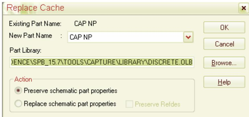
Browse 选择元件库，new part name 栏选择新的元件，该元件用来替换原来的元件。Action 中选择是否保留原来的属性，如果选择，那么原来的元件编号等信息保留，如果选择 replace schematic properties，原来的属性全部丢失，使用元件库中的默认属性替换。OK，执行替换。
