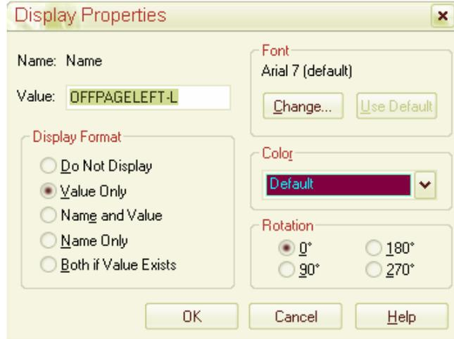
在 value 中填入网络名称。然后拖动 offpage connector 图标到建立连接的位置。同样在另一个页面，该网络的另一端也放好同名的 offpage connector 即可，这样就在两个原理图页面建立了电气连接。两个页面内都放好后如图所示。
