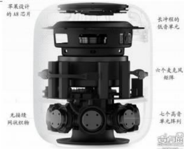
图表30 苹果 HomePod 智能音箱结构图
